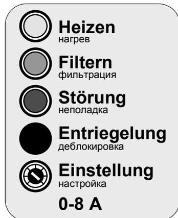
Трёхфазный фильтрующий насос защищен электроникой находящейся на съемном модуле от повреждений вызванных токовой перегрузкой. Для настройки защиты под конкретный насос необходимо согласовать величину тока срабатывания защиты с рабочим током фильтрующего насоса (смотри табличку на двигателе). Если же рабочий ток двигателя насоса не известен, то можно настроить защиту следующим образом:
