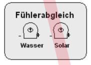
Электронный терморегулятор и термодатчик настраиваются относительно друг друга на заводе. В случае замены датчика или удлинения его провода при необходимости следует выполнить их повторную настройку с помощью потенциометров в управляющем приборе. Вращение потенциометра термодатчика по часовой стрелке вызывает увеличение отображаемого значения температуры воды. При вращении потенциометра термодатчика солнечного нагрева по часовой
