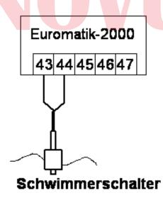
В качестве сенсора следует использовать поплавковый мини-выключатель Провод поплавкового выключателя может быть удлинен с помощью провода (2х0,75 мм²) до длины 100 м. Обратите внимание: соединение должно быть водонепроницаемым. Соединительный провод поплавкового выключателя не должен прокладываться вместе с другими электропроводами.
