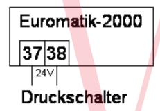
К клеммам 37 и 38 может подключаться пневмовыключатель, который монтируется в напорном трубопроводе или в разъеме для манометра центрального клапана. При замыкании беспотенциального контакта пневмовыключателя в течение более чем 10 секунд активизируется процесс обратной промывки. Через клеммы проходит напряжение 24 В.
