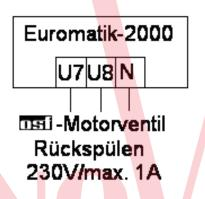
В случае недостаточного запаса воды при обратной промывке в сборном резервуаре недостающее количество воды можно взять из плавательного бассейна. К клеммам U7 и U8 можно подключать 2-ходовой клапан, который соединяется с системой донного выпуска. Во время процесса обратной промывки и промывки начисто этот клапан открывается; в остальных случаях он находится в закрытом положении. К этому контакту может подводиться ток 1 А напряжением 230 В. Клемма U7 Откр, клемма U8 Закр.
