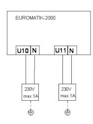
К клеммам U10 и N можно подключать поршневой клапан 230 В для обратной промывки.
