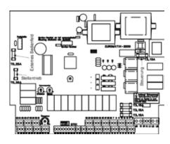
Электронная система управления защищена слаботочным предохранителем на 3,15 А, внешняя панель управления и сервопривод также защищены слаботочными предохранителями соответственно на 0,25 А, установленными на управляющей плате внутри прибора. Для систем нагрева, дозирующего устройства и дополнительного выхода предусмотрен слаботочный предохранитель на 3,15 А. Следует убедиться в обеспечении защиты при коротком замыкании фильтрнасоса (установить входные предохранители на макс. 16 А).
