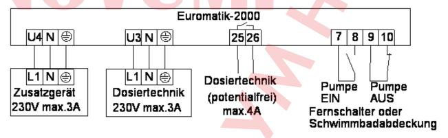
К клемме U4 возможно подключение дополнительного прибора 230 В (например, подводного прожектора), который может включаться и выключаться с помощью одной кнопки на передней крышке (или на внешней панели управления).
