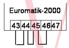
Если встроенная система регулирования уровня не используется, клеммы 43, 44, 45 и 46 должны быть соединены перемычкой.
