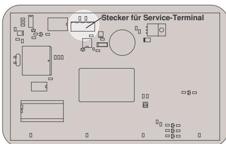
Для оптимальной адаптации блока управления к различному оборудованию, а также для облегчения ввода в эксплуатацию и последующего обслуживания можно к блоку управления подключать osf-Service-Terminal (Арт.Н.3010000900). Соответствующий разъем находится на внутренней стороне монтажной платы лицевой панели.
