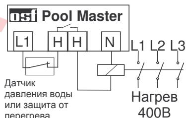
Контакты Н-Н допускается нагружать напряжением до 230В и током до 4А. Для управления трехфазными нагревателями 400В необходимо использовать дополнительный внешний контактор.
