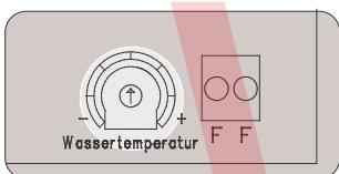
Электронная схема регулирования температуры и датчик согласованы между собой. В случае замены датчика или удлинения его кабеля, необходимо с помощью потенциометра находящегося в отсеке с клеммами провести новое согласование. Вращение потенциометра по часовой стрелке приводит к увеличению показания температуры.
