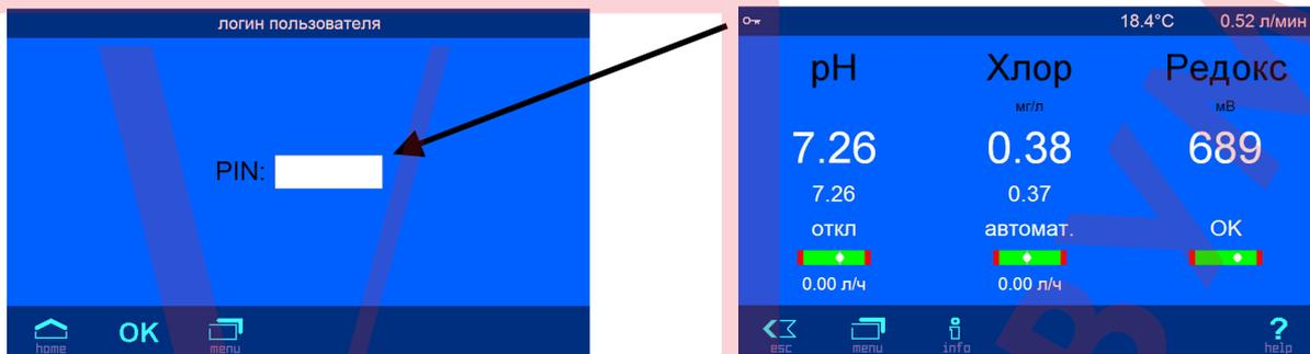
**Внимание:** страницы веб-сервера находятся на SD-карте, и поэтому при отсутствии SD-карты веб-сервер выдает лишь одну страницу с текущими параметрами воды бассейна «MRD3 7.26pH 0.38ppm 689mV 0.52l/min»
