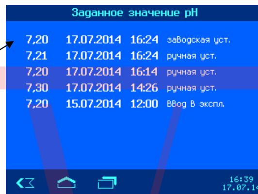
Аналогично выглядят архивы проведенных калибровок для датчиков хлора и редос, в которых сохраняется величина смещения. Архив проведенных калибровок датчика pH сохраняет также крутизну и проводилась ли калибровка по одной или по двум точкам. В случае проведения калибровки по одной точке величина крутизны берется из предыдущей калибровки.
