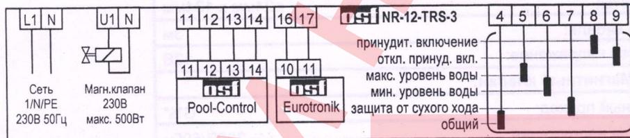
На примере показан вариант подключения с блоками управления фильтрацией серии Pool-Control от компании **DSI**.
