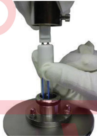
Описание пункт 4 При смене УФ-лампы наденьте перчатки! 4-контактный разъем ослабить легкими наклонными движениями
