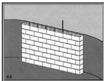
Используйте для строительства опорной стенки, монтажные кирпичи или блоки шириной 24см. Вставьте армировочные прутья (10мм) в отверстия сверху вниз (Рис. В5), а затем залейте отверстия бетоном. Бетонную подушку на полу нужно также путем армировки связать с опорными стенками.
