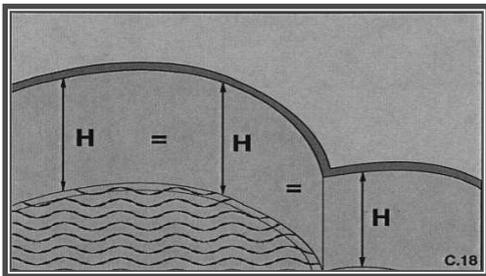
**Проверьте:** в местах натяжения пленки при легком нажатии руки Ваша рука должна коснуться стенки бассейна — это идеальное натяжение для пленки.
