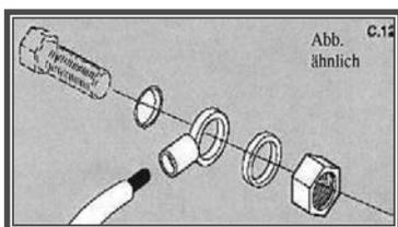
Просверлите дырочку (5,5мм) непосредственно над нижним профилем и прикрепите комплект заземления (не входит в комплект поставки) к головке дюбеля с внутренней стороны (который прикрепляет металлическую стенку бассейна к опорной стенке)!
