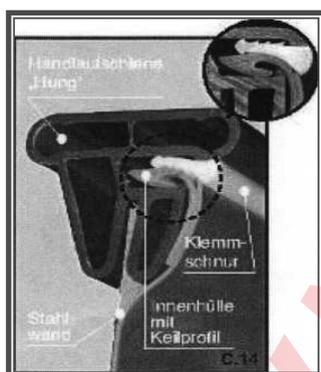
Закрепите полностью верхние профили на металлической стенке бассейна (при необходимости укоротите один профиль). Вставьте пленку кантом в специальное отверстие в профиле, а затем закрепите ее специальным силиконовый шнуром во избежание выскальзывания пленки из профильного крепления.
